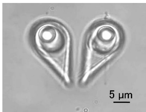
図 13 複製したマイクロピンセットの光駆動.
