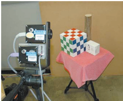
図10 カラー CCD カメラを加えたシステムによる物体計測の様子。
