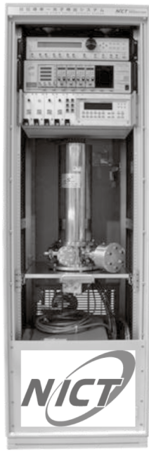
図5 GM 冷凍機を用いたマルチチャンネル SSPD システム。
