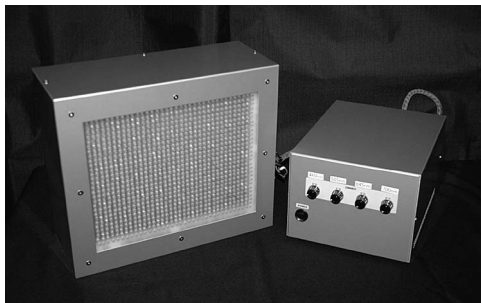
図2 試作した異物検査用 LED 照明.
