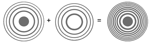
図5 ダブルパターニング法の模式図 (W. Chao ら)。
