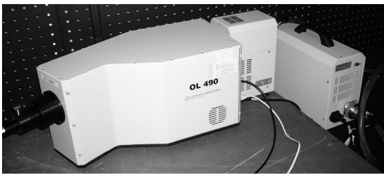
図6 波長掃引単色照明の生成に用いた波長プログラマブル光源。
