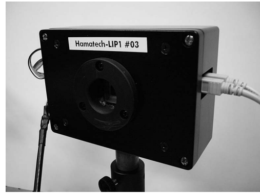
図3 390 \times 366 画素 CIS カメラ.
