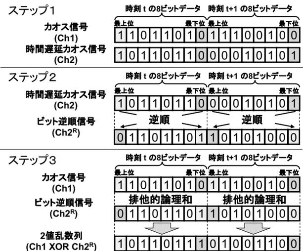
図3 乱数生成後処理の一例(ビット列逆順方式)。
