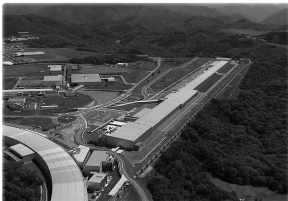
図2 SACLA全景。中央右上から左下に向かう直線状の建屋がSACLA収納建屋。左下円弧状の建屋はSPring-8。SACLA線形加速器は、右上から始まり、建屋幅が広がった部分からアンジュレータホールがはじまる。高さが増えた部分が実験ホール。この部分までで全長約700mあるが、XFELビームはさらに左下の道路をくぐり、次の建屋内に導入される。ここには、SPring-8のビームも導入されており、XFELと放射光の2つのビームを同一試料の同一位置に導くことが可能である。
