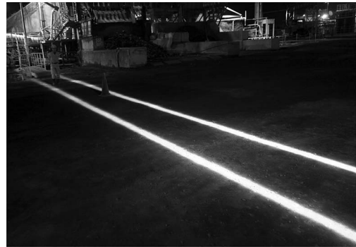
図8 安全補助用として通路照明実験の様子。高さ4mの地点に装置を2台設置し、斜め下方向に長さ約20mの直線状パターンを2本形成。
