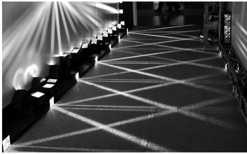
図6 床面と壁面の演出照明実験の様子。床面設置した装置にプリズム素子を用いて複数の直線状パターンを形成。
