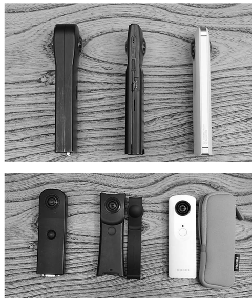
図3 2種類のプロトタイプ (初期プロトタイプ：左, 中期プロトタイプ：中央) と製品版 THETA (右)。
