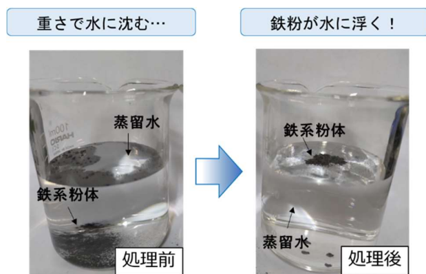
図 13 疎水性 SAM 形成前後の鉄系粉体の様子
