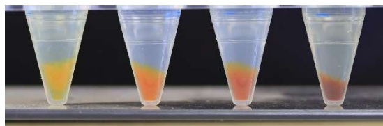
図 2 酸素プラズマ処理により生成された酢酸鉛の沈殿物。
