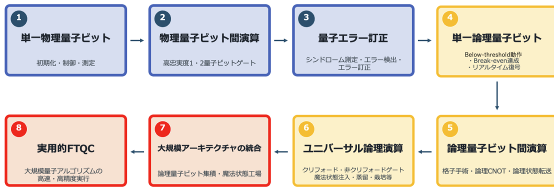
図1 実用的な誤り耐性量子コンピュータ (FTQC) の実現に向けた技術ロードマップ。青色は原理実証が既に達成された技術、黄色は小規模実証が進みつつある技術、赤色は大規模統合を含む今後の主要課題を示す。なお、各段階は必ずしも直線的に進むものではなく、複数の技術レイヤーが並行して開発される。
